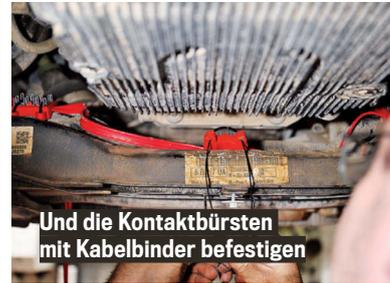
Und die Kontaktbürsten mit Kabelbinder befestigen
