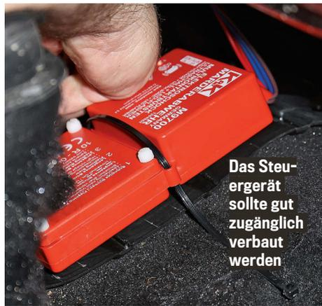
Das Steuergerät sollte gut zugänglich verbaut werden
