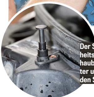
Der Sicherheits-Motorhaubenschalter unterbricht den Stromkreis
